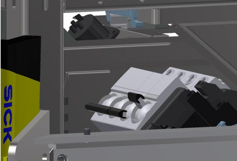
4. Der Batterietrennschalter hinten rechts muss eingeschaltet sein (die gelben Indikatoren stehen bei ON).
