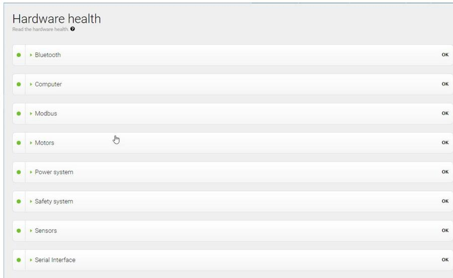
Abbildung 16.1. Auf der Benutzeroberfläche unter **Hardwarezustand** (Hardware health) wird angezeigt, welche Komponente fehlerhaft ist. In vielen Fällen wird sogar die Ursache angegeben.
