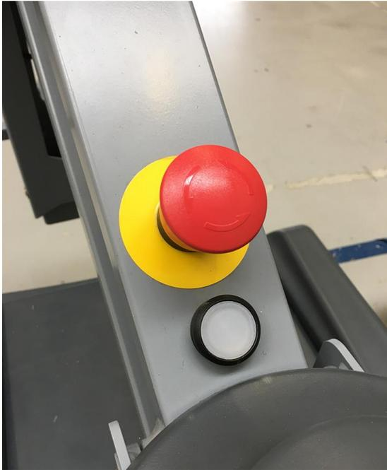
Wenn sich der Roboter im Sicherheits- oder Not-Halt befindet, schaltet die Sicherheits-SPS die Spannungsversorgung der Motorsteuergeräte am Haken ab. Das bedeutet, dass der Haken nicht bremsen oder hoch- oder runtergefahren werden kann und sich der Greifer weder öffnen noch schließen lässt.
