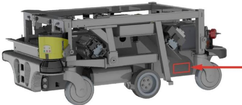
Abbildung 2.2. Position des Kennschields am MiR100.
