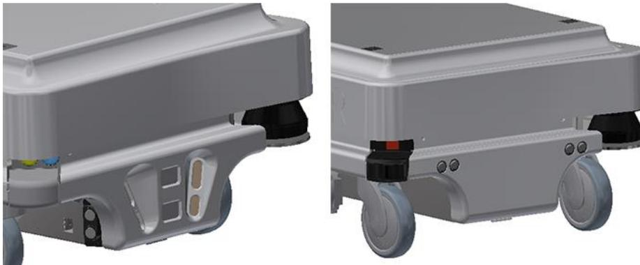
Abbildung 7.10. Der Roboter verfügt über zwei Ultraschallsensoren vorne (links) und zwei hinten (rechts).
