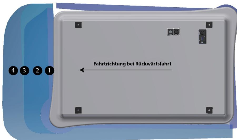
Die Abbildung zeigt die Schutzfeldkonturen während der Rückwärtsfahrt. Die Reichweite des Schutzfelds verändert sich mit der Geschwindigkeit des Roboters. Die Abbildung zeigt auch, wie der Frontscanner das Schutzfeld auf ein Minimum reduziert, wenn der Roboter rückwärtsfährt.
