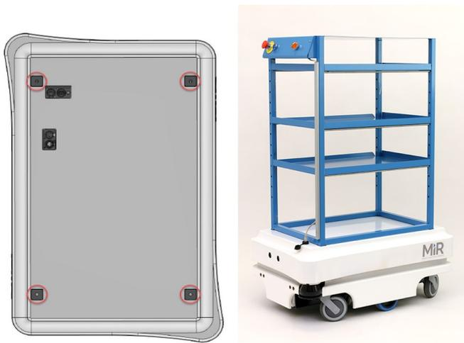
Aufsatzmodule werden mithilfe der Arretieraufnahmen in der oberen Abdeckung befestigt.
