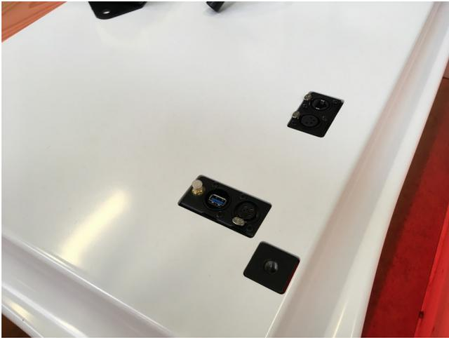
6. Montieren Sie die Not-Halt-Box auf der Roboterabdeckung und schließen Sie sie an.
